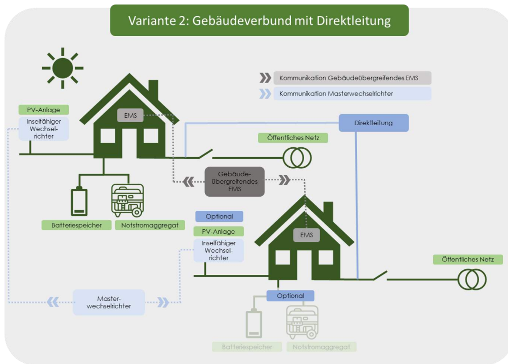
Abbildung 35: Variante 2 – Gebäudeverbund mit Direktleitung, eigene Darstellung
